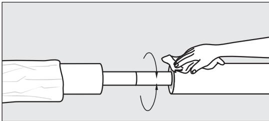
3. Alle Oberflächen der Verbindung reinigen.
