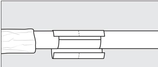
8. Schrumpffolie so anbringen, daß der Markierungstrich um das Rohr herumläuft und eine ihrer Kanten in „10-Uhr-Position“ befestigt ist. Schrumpffolie um das Rohr durch Abziehen des Schutzpapiers herumführen, so daß die Folie an der darunter liegenden Oberfläche anliegt.
