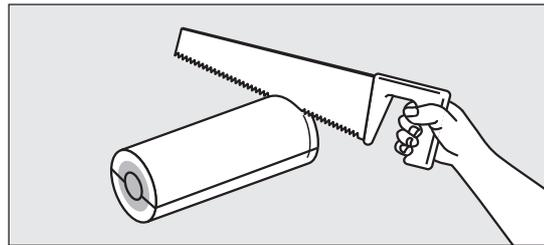
4. Dämmschalen kürzen, so daß sie stramm zwischen die Mantelrohrenden passen.
